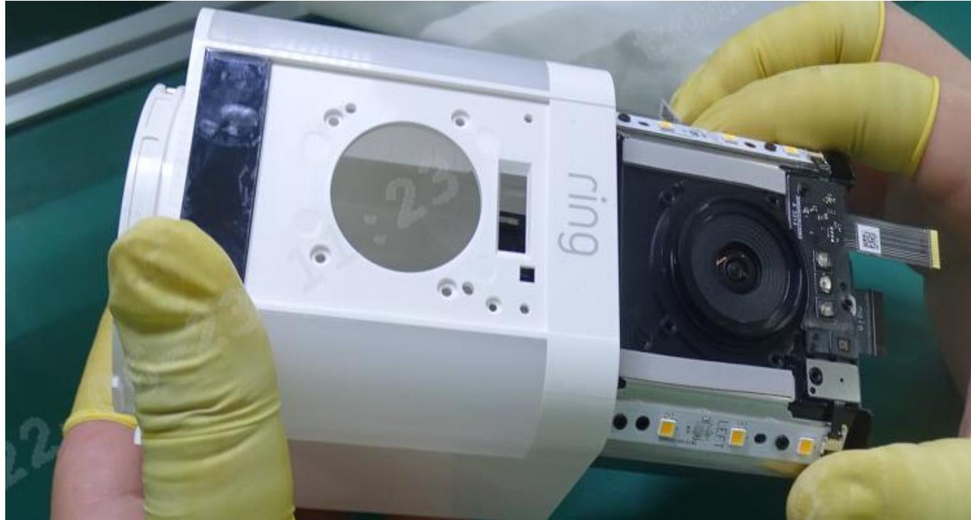
Libera la posizione della fibbia del circuito stampato del sensore con un palanchino. Sull'altro lato, apri la fibbia e spingi il circuito stampato per rimuoverlo dall'alloggiamento superiore.
