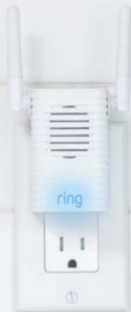
Es ist gleichzeitig ein WLAN-Extender, der die Reichweite Ihres Netzwerks erweitert und das WLAN-Signal an Ihre Ring-Geräte verstärkt.
