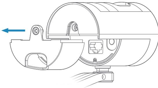
**No vuelvas a colocar esta tapa hasta completar la instalación!**
