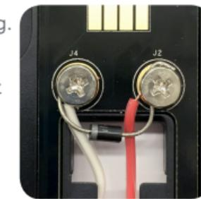
Bei einem digitalen Glockenschlag entsteht kein Schaden, wenn die Diode falsch herum befestigt wird. Falls Ihr Glockenschlag nicht ertönt, drehen Sie die Diode einfach herum.
